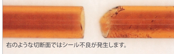
図 2: 茶色のリングはシールが適切であることを示しています。
