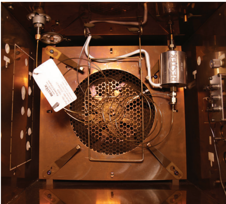
Figure 10 : Colonne connectée à l'injecteur et au méthaniseur.
