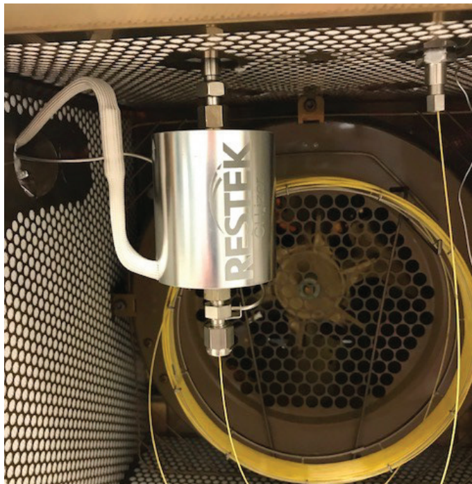
Figure 9 : Colonne connectée à l'injecteur et au méthaniseur
