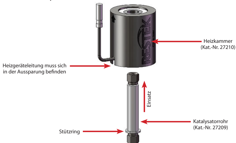
Abbildung 5: Heizkammer und Katalysatorrohr
