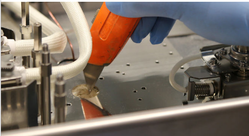
Abbildung 3: GC-Ofen-Blende und Isolierung entfernen
