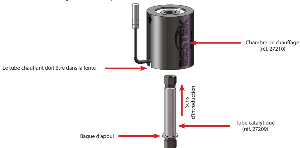
Figure 5 : Chambre de chauffage et tube catalytique
