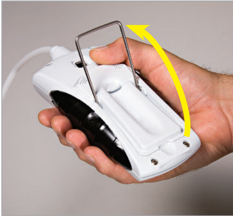
図2：電池カバーを開ける前に、ワイヤースタンドを立ち上げます
