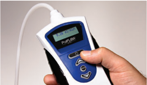
图 5：LED 显示测得的流量值。
