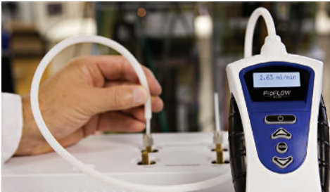
图 4：探管连接到 GC 气体出口。
