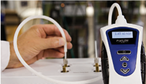
Figura 4: Sonda conectada a una salida de gas de GC.
