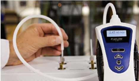
Abbildung 4: Prüfspitze an einen GC Gas Outlet angebracht
