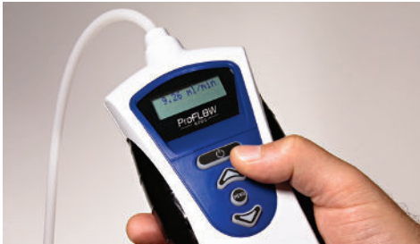
図5：LEDが測定された流量値を表示します
