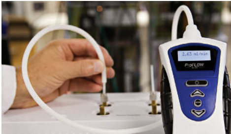
Figura 4: Sonda collegata a un'uscita gas GC.
