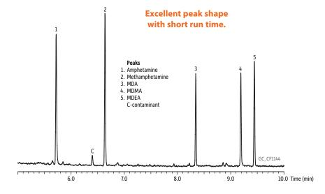
**Column** Rxi-5Sil MS, 30 m, 0.25 mm ID, 0.25 μm (cat.# 13623)
