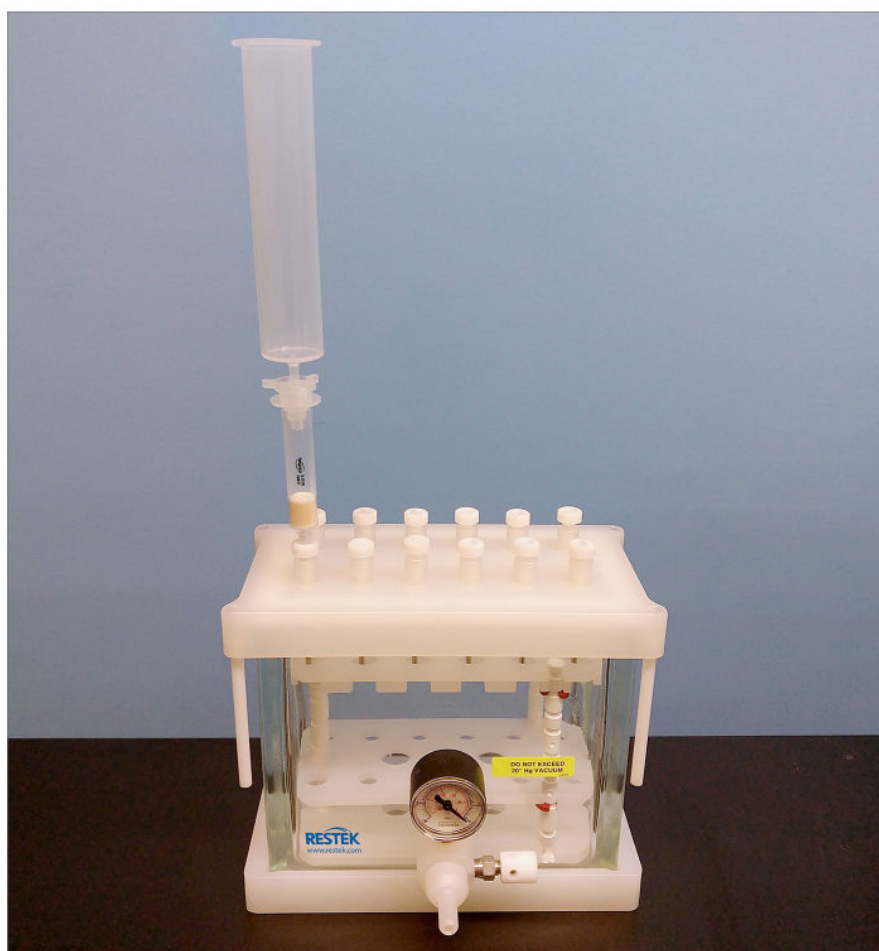
Figure 1 : Configuration utilisée pour la préparation d'échantillons, avec des réservoirs montés sur les cartouches SPE Resprep S-DVB elles-mêmes montées sur le « manifold » sous-vide.
