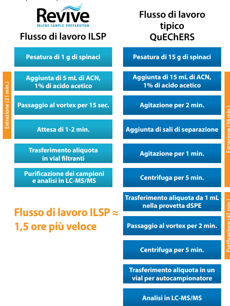
Figura 1: La preparazione del campione in linea Revive ha impiegato un'ora e mezzo in meno rispetto a un flusso di lavoro tradizionale QuEChERS per 14 campioni di spinaci.
