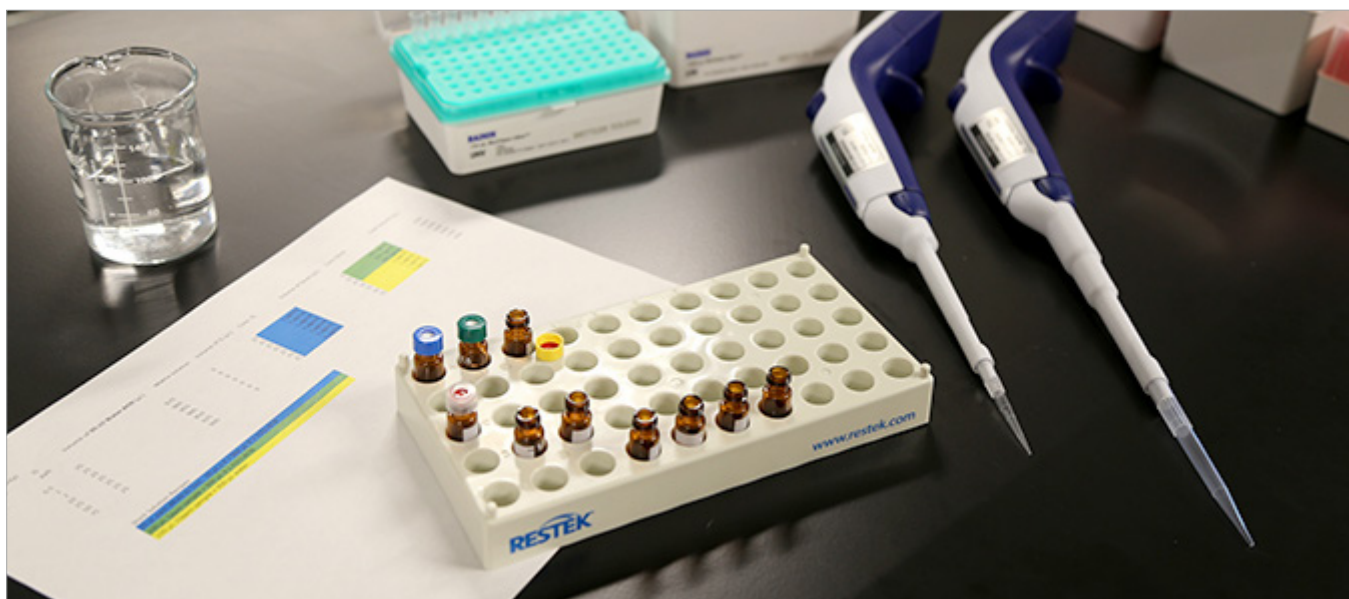
Figure 4 : L'utilisation d'un mode opératoire précalculé avec un code de couleurs pour la préparation des solutions étalons de calibration, et la manipulation des flacons dans un portoir permettent de suivre la progression des étapes pour éviter les erreurs coûteuses.
